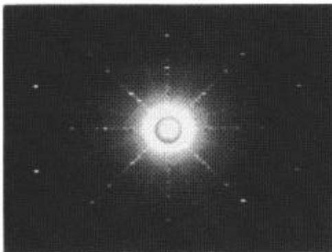
図 2 [001]_c 方向に X 線をあてた時のラウエ写真
